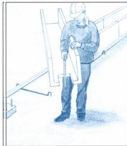
3. Plaats de EPS-bekistingselementen langs houten regels 45 x 70 mm
